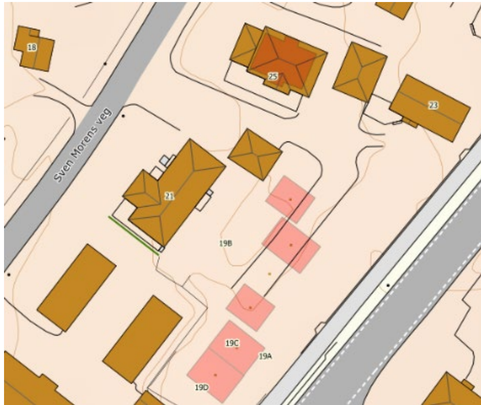
Figur 1 - Byggnaden nr 25 visar både takytor och bottenytan (planläge=fasad i mörkare brunt), dvs den visar motsvarande NS LOD 2.1a i 2D. Övriga bruna byggnader visas motsvarande NS LOD 2.1b i 2D. De rosa fyrkanterna visar planerade byggnader efter beviljat bygglov som redovisas motsvarande NS LOD 0c. (Bild: Norgeskart.no)
